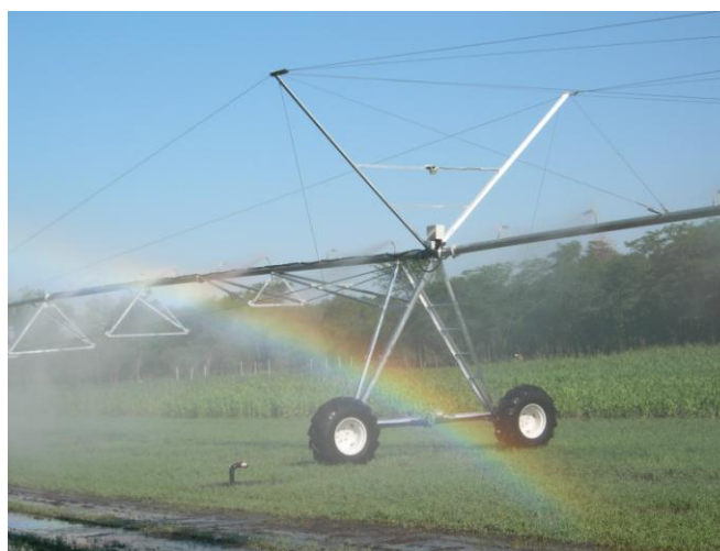
Рисунок 3 – Дождевальная машина «Кубань» (автор фото В. Н. Сосницкий)
