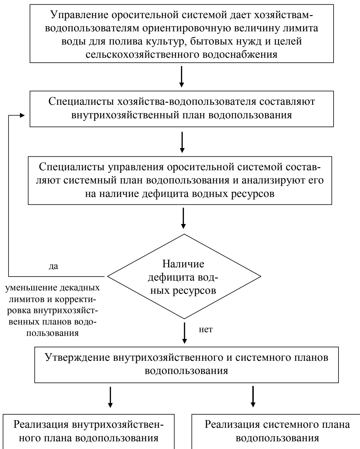
Рисунок 1 – Блок-схема технологии планирования и реализации водопользования на оросительных системах
